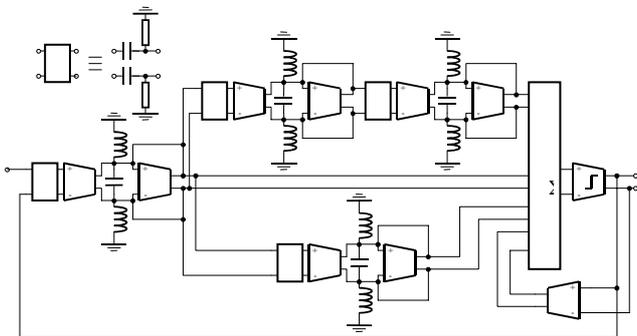
Figure 7 . Vue générale du modulateur sigma-delta d'ordre 6
