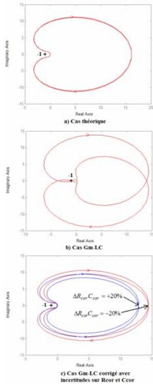
Figure 3. Diagramme de Nyquist du bloc de filtre: a) cas idéal b) cas Gm-LC c) cas Gm-LC corrigé par passe-haut
