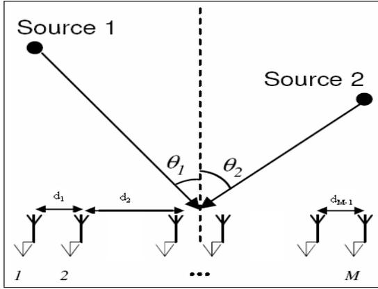
Figure 1. Principe de l'estimation de direction d'arrivée
