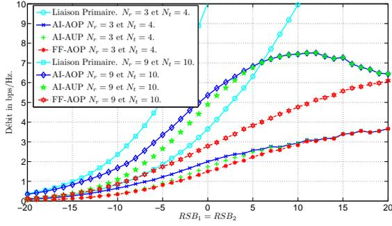
FIG. 2: Débit du système opportuniste comme fonction du rapport signal sur bruit  $RSB_1 = \frac{p_{\max}}{\sigma_1^2}$ . Le nombre d'antennes satisfait  $N_t = N_r + 1$ , avec  $N_r \in \{3, 9\}$  et  $RSB_1 = RSB_2$ . La technique de formation de faisceaux (FF) à forçage de zéro suit l'équation (Eq. 5) avec puissance optimale.
