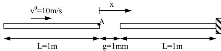
Figure 2 – Impact entre deux barres élastiques
