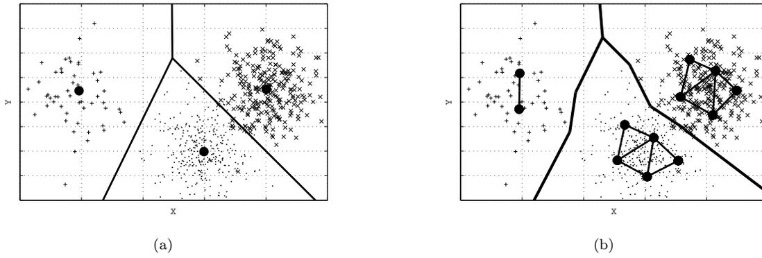
FIG. 2 – Exemple de quantification vectorielle pour un mélange gaussien à trois composantes (dimension 2) : prototypes et partition (ligne épaisse) obtenus par K-moyennes avec  $K = 3$  (a) et par GNG-T (b) avec le graphe associé. Les croix (x) et les signes plus (+) représentent des échantillons de la distribution, les gros points sont les prototypes obtenus, reliés par des arcs seulement pour le GNG-T.
