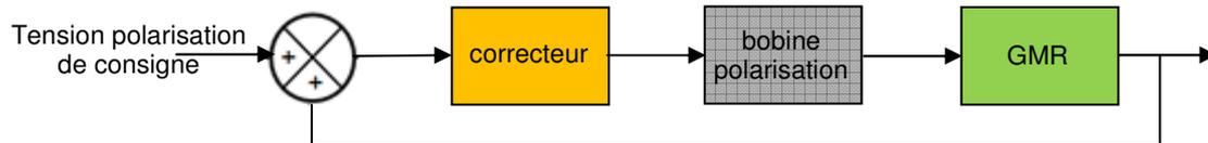
Figure 11 : Schéma bloc de la structure d'asservissement réalisée.
