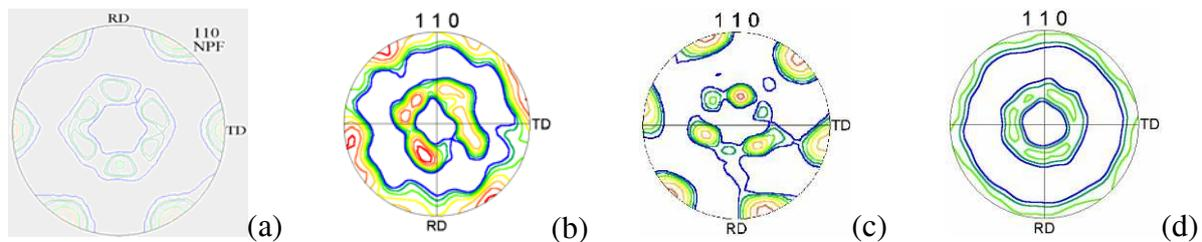
**Fig. 9.** Figures de pôles  $\{110\}$  du Ti 17 après forgeage : (a) mesure par diffraction de neutrons après 60 % de déformation, (b) simulation pour une couche seule, (c) pour l'agrégat réel, (d) pour l'agrégat isotrope.
