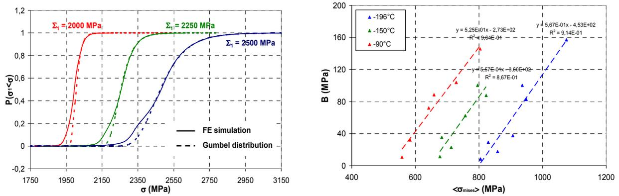
**Fig. 21.** Identification de la distribution de Gumbel sur les hétérogénéités de  $\sigma_1$  simulées ( $T = -196^\circ\text{C}$ ,  $\chi = 2,5$ ) et évolution de  $B$  en fonction de  $T$ ,  $\langle \sigma_{mises} \rangle$  et  $\chi$ .
