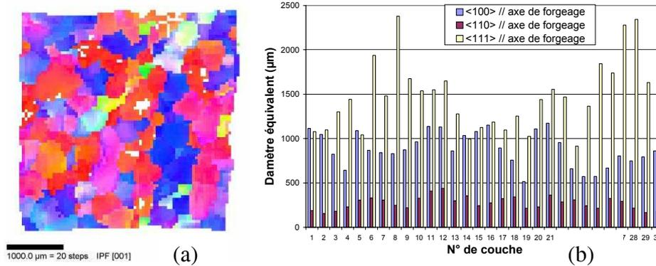
**Fig. 8.** (a) Simulation de l'orientation de l'axe de forgeage dans une couche de l'agrégat de Ti17. (b) Diamètre des grains pour les 3 principales composantes de texture (graphe déduit des textures et des tailles de grains obtenus par simulation).
