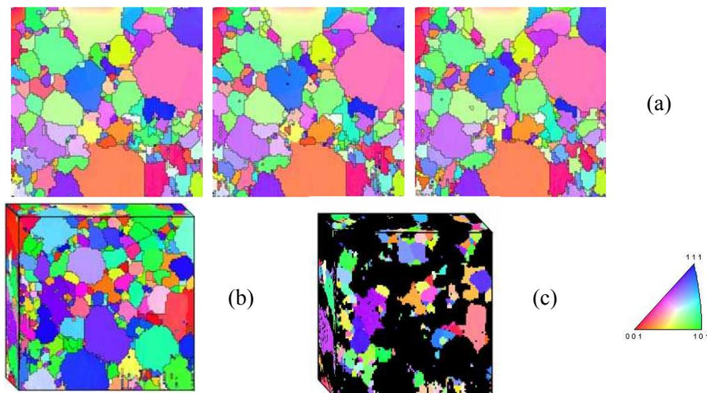
**Fig. 1.** Exemple d'agrégat tridimensionnel Mo-30 %TiC obtenu par FIB (Max Planck Institute, Düsseldorf) : (a) exemple de quelques couches obtenues, (b) reconstruction de l'agrégat, (c) reconstruction de la seule phase TiC.
