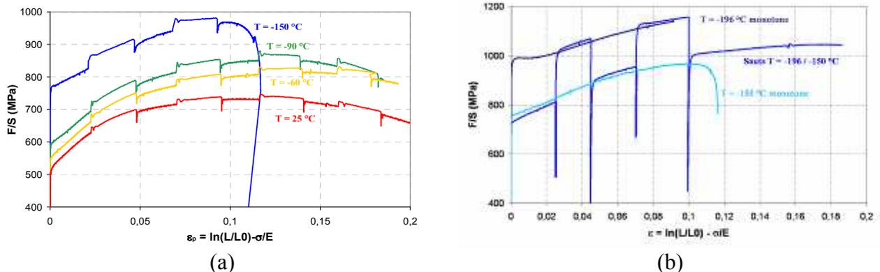
**Fig. 18.** Essais sur la bainite : (a) sauts de vitesse à  $\dot{\epsilon} = 5 \cdot 10^{-4}$  et  $5 \cdot 10^{-3} \text{ s}^{-1}$  ; (b) sauts de température à  $\dot{\epsilon} = 5 \cdot 10^{-3} \text{ s}^{-1}$ .
