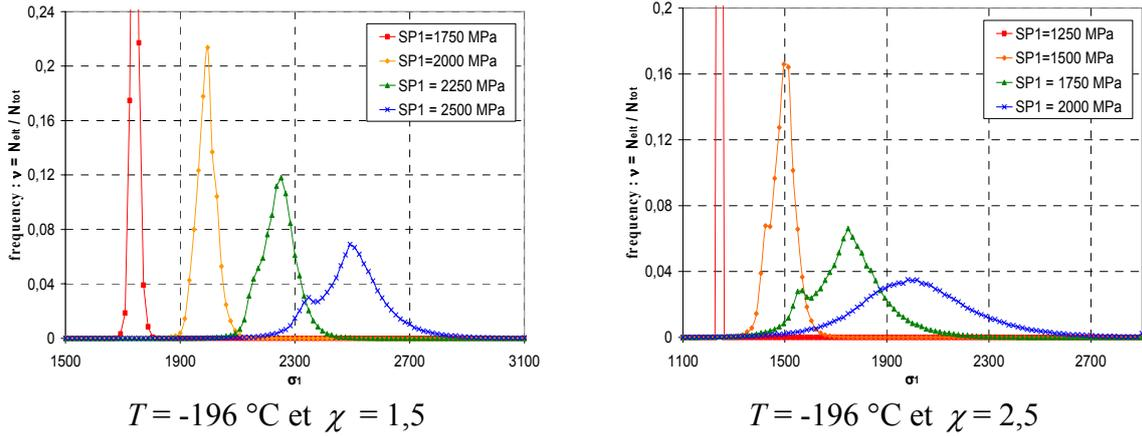
**Fig. 20.** Histogrammes de distribution de la contrainte principale max.  $\sigma_1$  dans l'agrégat, pour différentes amplitudes de la contrainte principale moyenne  $\Sigma_1 = \langle \sigma_1 \rangle = SP1$ .
