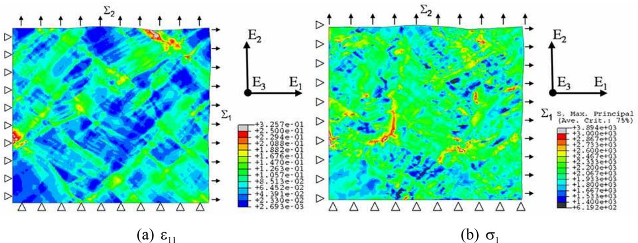
**Fig. 19.** Calcul de plasticité cristalline en déformations planes à  $T = -196\text{ °C}$  et à triaxialité imposée de 1,5 ( $\Sigma_1 = 2000\text{ MPa}$ ,  $\Sigma_2 = 890\text{ MPa}$ ,  $E_{33} = 0$ ). Cartographies (a) de la composante de déformation  $\varepsilon_{11}$  et (b) de la contrainte principale maximale  $\sigma_1$ .
