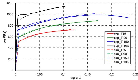
**Fig. 17.** Courbes de traction de la bainite à différentes températures.
