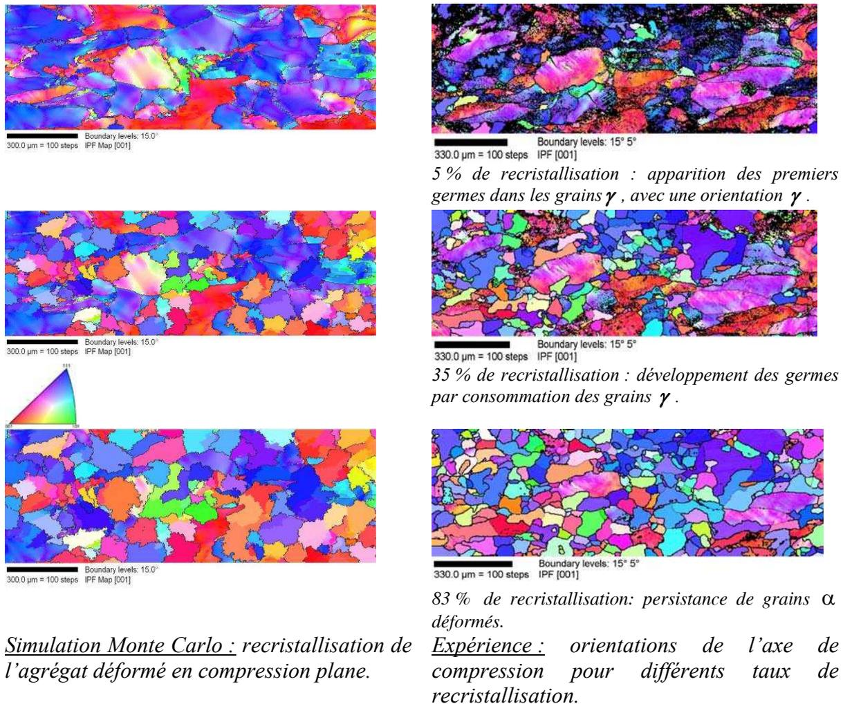
**Fig. 15.** Simulation de la restauration/germination/croissance et résultats expérimentaux.
