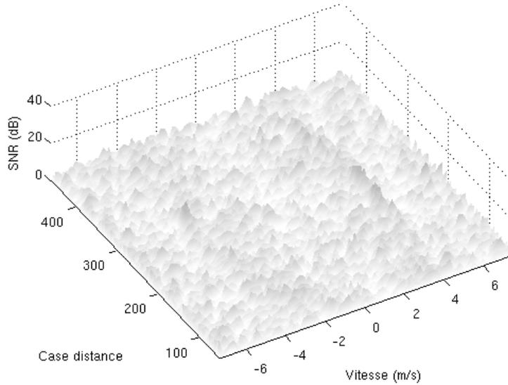
**Figure 10.** *Détecteur MLED sans sur-éch. – cibles décalées d'1/2 case*
