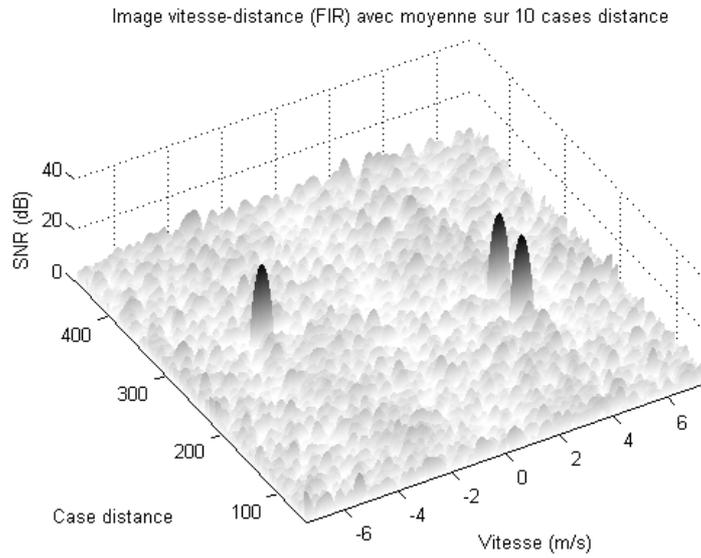
**Figure 5.** *Filtre FIR de référence avec moyenne sur 10 cases distance*
