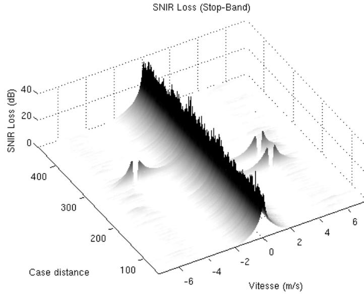
**Figure 15.** Perte SNIR avec le détecteur Stop-Band APES
