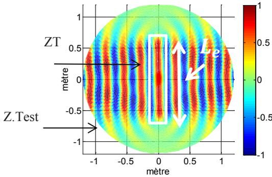
Fig. 2. : Distribution de champ de l'onde entretenue dans la zone de test à la fréquence centrale,  $f_c = 1.1\text{GHz}$ ,  $B_T = 0,3\text{ GHz}$ , avec une zone tranquille de dimension électrique  $L_e = 5\lambda_c$ .
