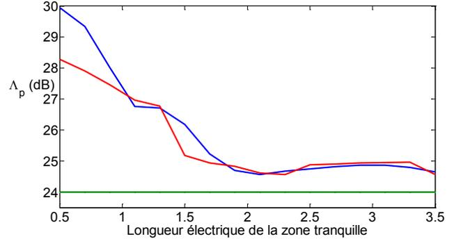
Fig. 3. Contraste de pic dans la zone tranquille en fonction de la longueur électrique  $L_e$ ; courbe bleue et rouge respectivement avec et sans optimisation, courbe verte contraste de pic requis pour le test [3].
