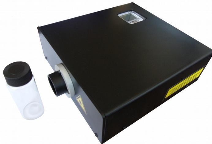
Figure 1 - Exemple d'un spectromètre expérimental «bas coût» développé par le laboratoire LMOPS permettant une mesure *in situ* et rapide ; ce capteur est compact ( $20 \times 18 \times 3$  cm<sup>3</sup>).
