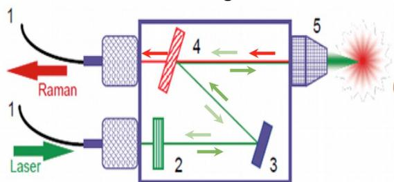
La figure ci-dessus décrit une tête Raman : le laser (rayon en vert) arrive par fibre optique (1) sur cette tête, passe par un filtre (2) pour épurer le rayon laser, est réfléchi par le miroir (3) sur le filtre edge (4) et passe par l'objectif (5) pour analyser l'échantillon (6).
