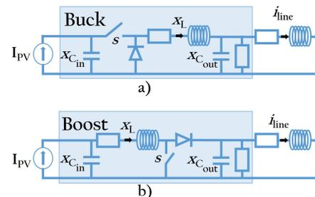
Fig. 2. a) Buck converter b) Boost converter
