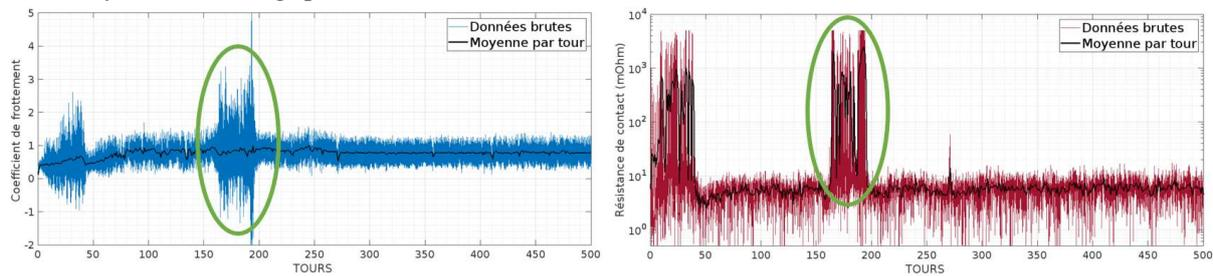
Figure 3: Coefficient de frottement et résistance de contact en fonction de la distance (zoom sur les 500 premiers tours) – Vitesse de rotation : 500RPM ; Charge : 0,25N ; 50 000 tours ; Intensité : 100mA ; Fréquence d'acquisition : 100Hz
