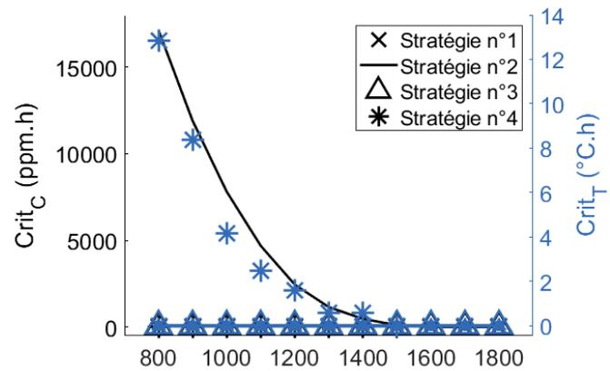
**FIG.4.** Impact des exigences en CO<sub>2</sub> sur la consommation. Les stratégies n°1 et n°3 respectent les contraintes de température et de concentration de CO<sub>2</sub>, caractérisant ainsi leur front de Pareto respectif.
