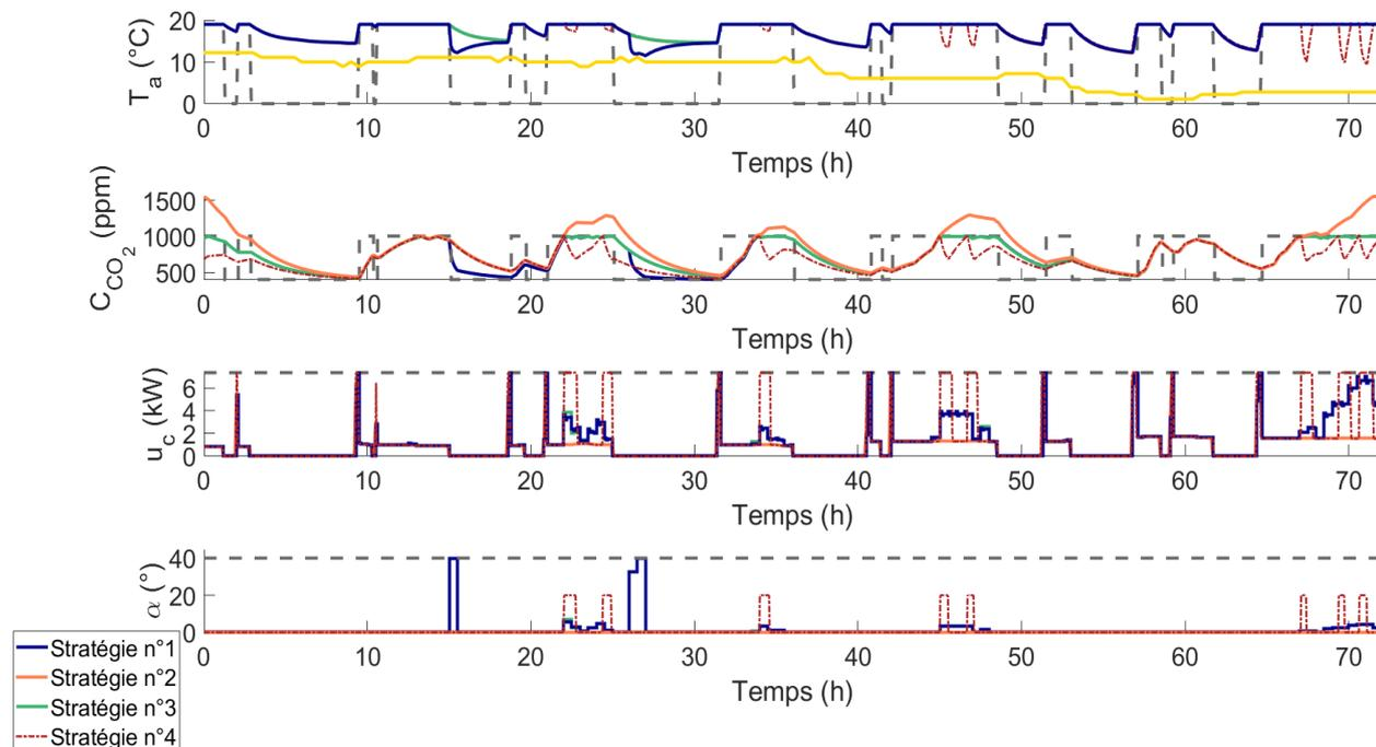
**FIG. 3.** Séries temporelles des températures intérieures,  $T_a$ , concentration en CO<sub>2</sub>,  $C_{CO_2}$ , et commandes de chauffage,  $u_c$ , et angles d'ouvertures,  $\alpha$ , sur une période de 3 jours des différentes stratégies – en jaune la température extérieure, en gris pointillé – les contraintes/consignes
