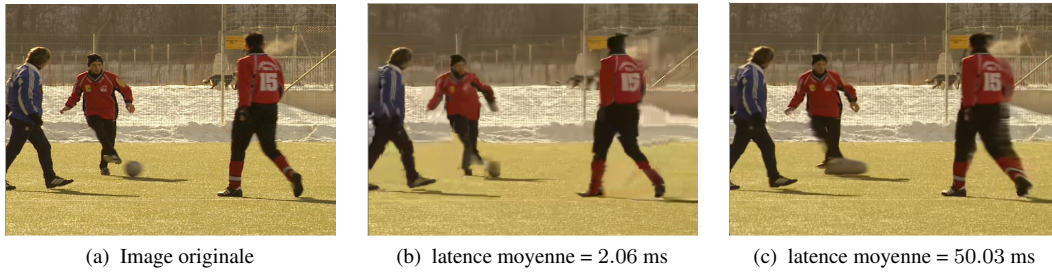
FIGURE 4 : Comparaison visuelle de Soccer ( R_E = 800 kb/s, C = 6 Mb/s) : (a) Image originale, (b) Réduction de débit ( \alpha = 1/8 , PSNR = 29.74 dB et SSIM = 0.74) et (c) Extrapolation ( h=3 , \Delta_X = 0 \times \Delta_F , PSNR = 29.07 dB et SSIM = 0.86).
