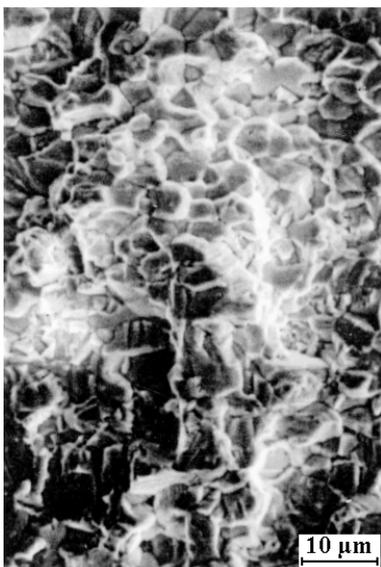
FIG. III-1. Développement intergranulaire. Zircaloy-4 recristallisé [Schuster et al. 1992].
