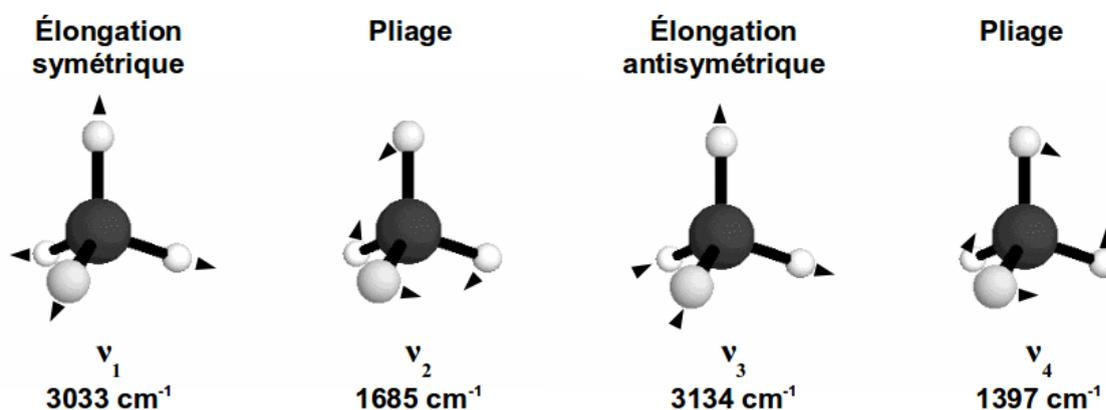
FIGURE 3.24 – Modes de vibration de l'ion libre ammonium.
