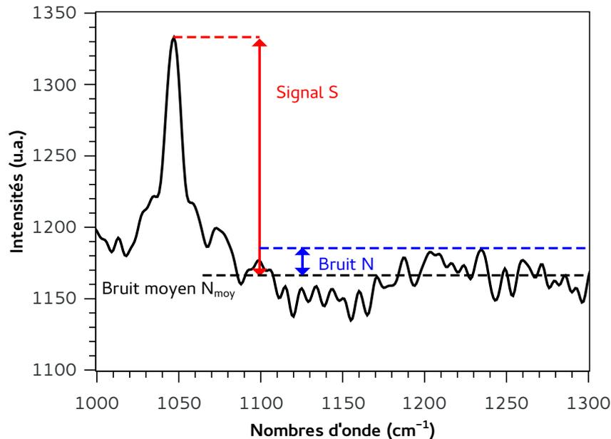
FIGURE 2.6 – Calcul du rapport signal/bruit  $SNR$ .
