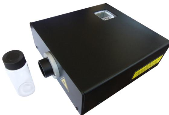
Démonstrateur d'un capteur Raman réalisé au laboratoire LMOPS.
