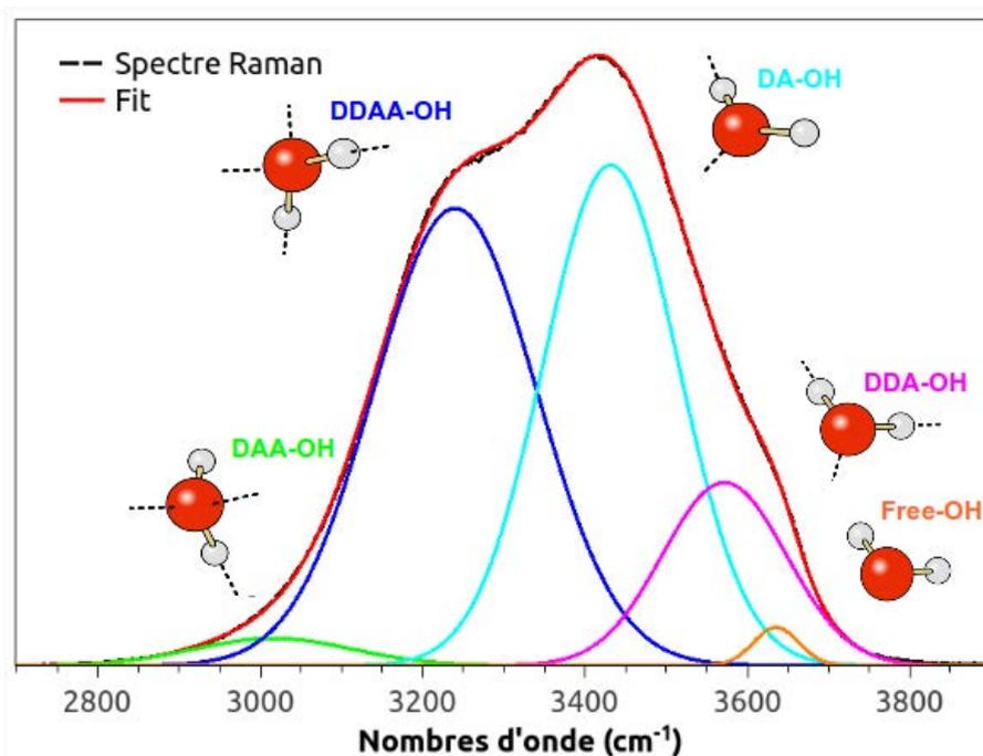
FIGURE 1.13 – Décomposition de la bande d'élongations O-H.
