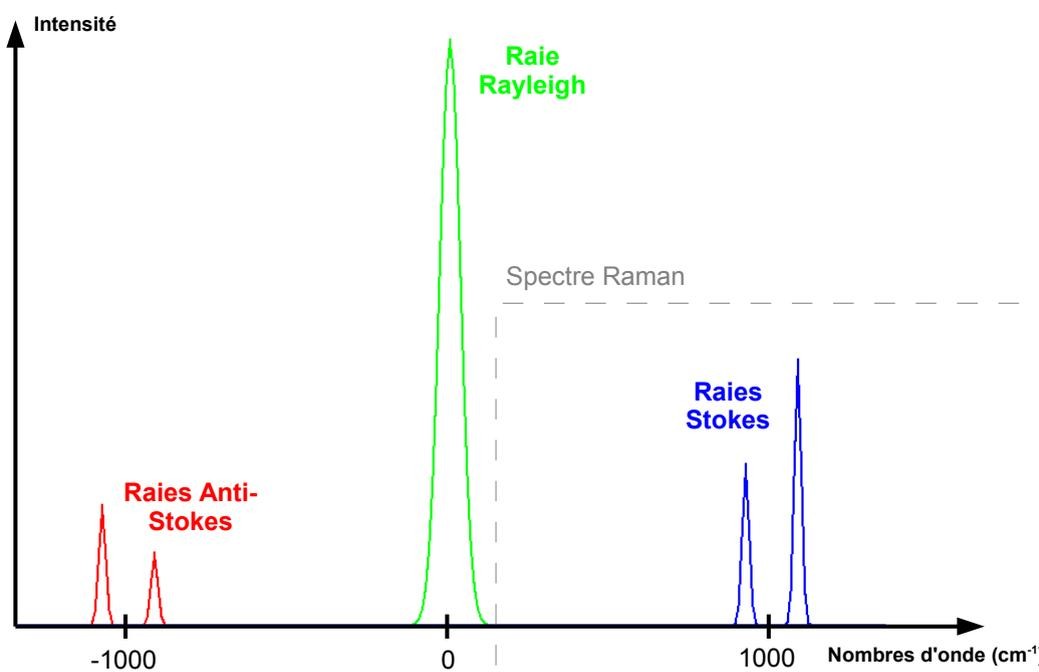
FIGURE 1.4 – Raies Stokes et Anti-Stokes symétriques par rapport à la raie Rayleigh.
