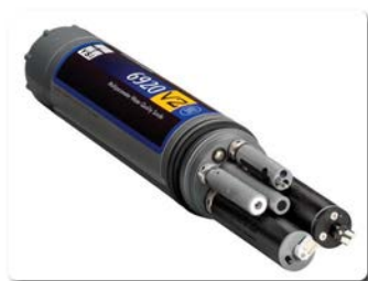
FIGURE 2 – Exemple de sonde ISE (YSI).
