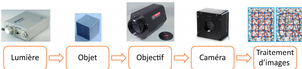
Figure 3-5 : Représentation de la chaîne de mesure dédiée à la CIN.
